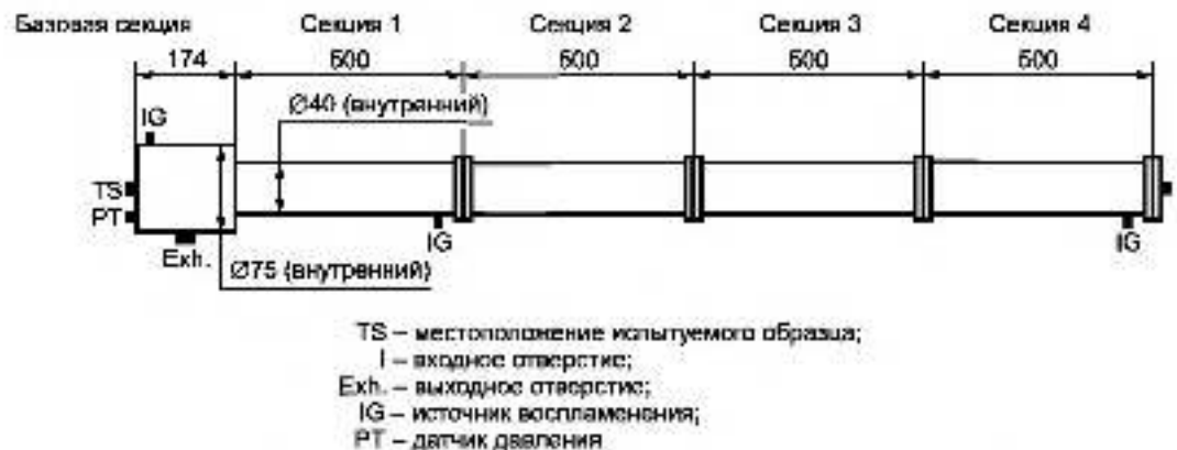
Рисунок 21 — Установка для испытаний дыхательных и дренажных устройств
