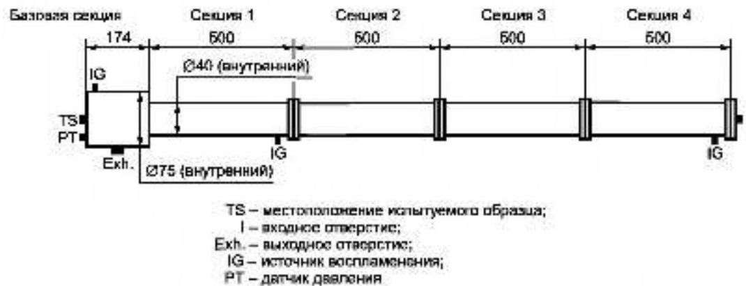
Рисунок 21 — Установка для испытаний дыхательных и дренажных устройств
